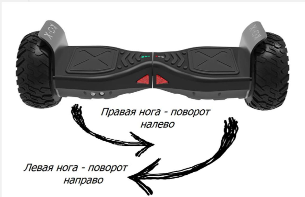
На наклон вперед гироскутер реагирует движением вперед. Если наклониться назад, то гироскутер замедлится, остановится и поедет задним ходом.
