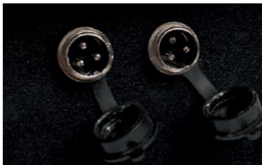
3. Откройте заглушку разъема для зарядки (см. рисунок), подключите к разъему зарядное устройство, включите зарядное устройство в сеть.
